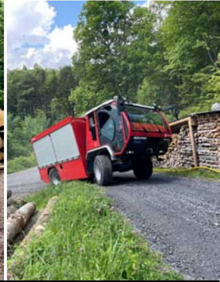
links: Das KTLF der Feuerwehr Flüelen wurde 2022 von der Firma Martin Rohrer (Feuerwehrtech) auf einem Schiltrac Eurotrans aufgebaut rechts: Durch die hohe Verwindungsfähigkeit des Rahmens mit bis zu 45 Grad ist das KTLF geländefähig. (Werkfotos)
