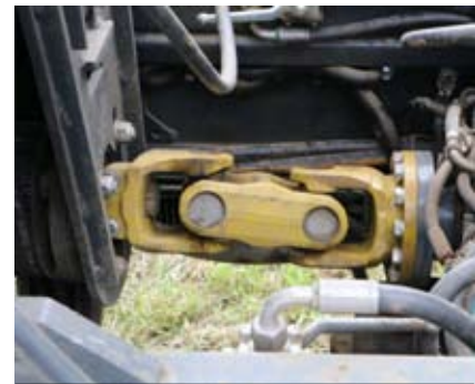
Leistungsfähige Zapfwelle im Fahrgestell-Rahmen (Fotos: J. Thorns)
