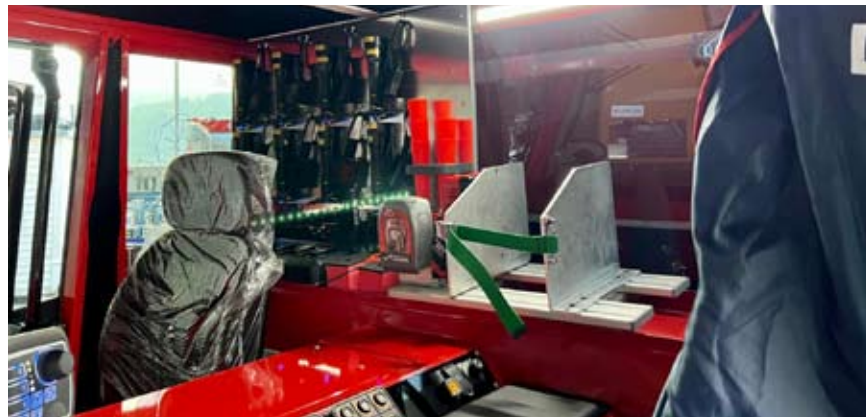
Blick in den Mannschaftsraum des KTLF der Feuerwehr Flüelen (Werkfoto)
