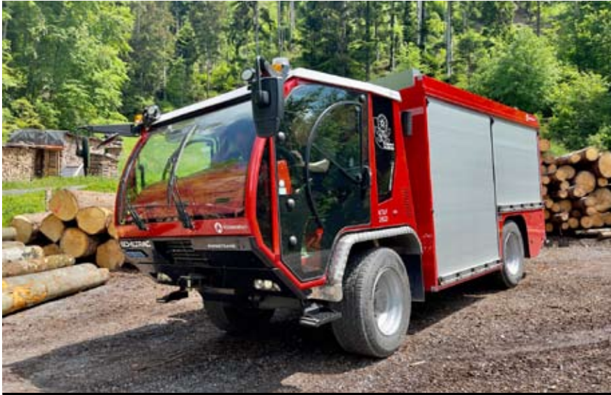
links: Das KTLF der Feuerwehr Flüelen wurde 2022 von der Firma Martin Rohrer (Feuerwehrtech) auf einem Schiltrac Eurotrans aufgebaut rechts: Durch die hohe Verwindungsfähigkeit des Rahmens mit bis zu 45 Grad ist das KTLF geländefähig. (Werkfotos)
