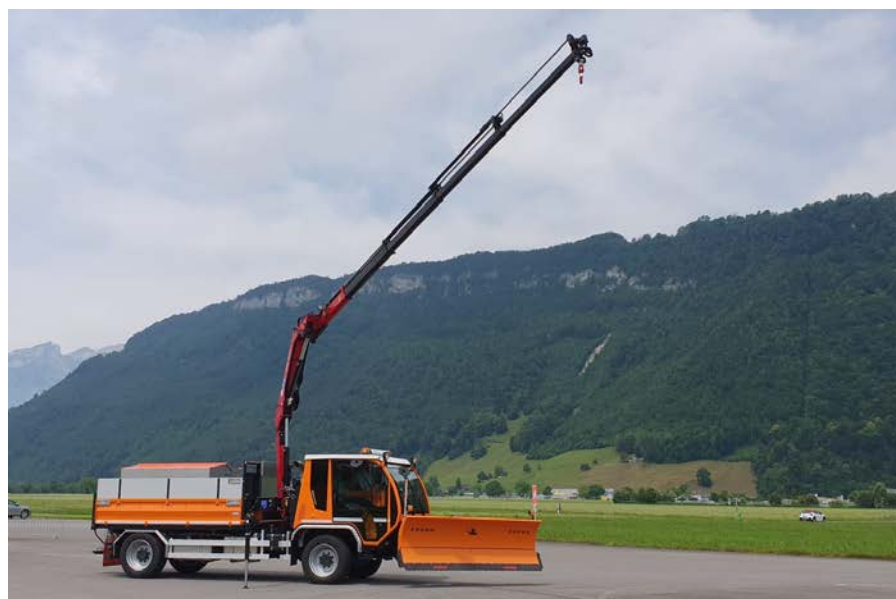
An- und Aufbauten – hier ein Pflug und ein Kran – erhöhen die Einsatzmöglichkeiten im Kommunalbereich.
