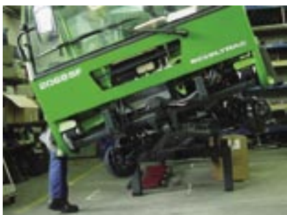
4 Durchgehende Rahmenbauweise des Chassis. Der Vorderwagen hat einen Pendelweg von 33°.
