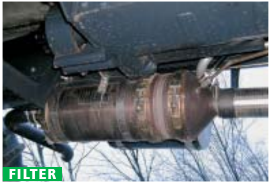
Der Partikelfilter ist nur wenig grösser als der original-Schalldämpfer und verursacht so kein Platzproblem.
