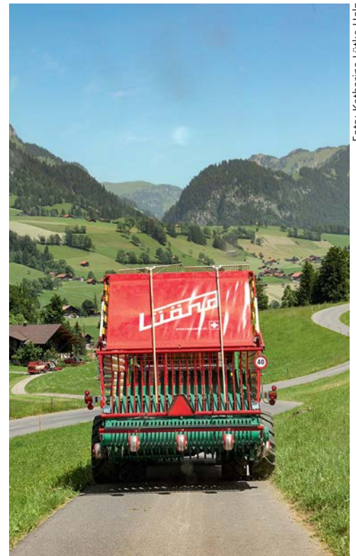
Auf der Strasse beschleunigt der Swisstrans auf bis zu 40 km/h bei 1750 U/min. Die Gesamtbreite mit der 20 Zoll grossen Zwillingssbereifung beträgt rund 2,80 m.
