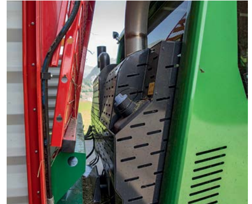
Rechts hinter der Kabine ist der Einfüllstutzen des 20l grossen AdBlue-Tanks. Der 160l fassende Dieseltank befindet sich weiter hinten neben dem Chassis.
