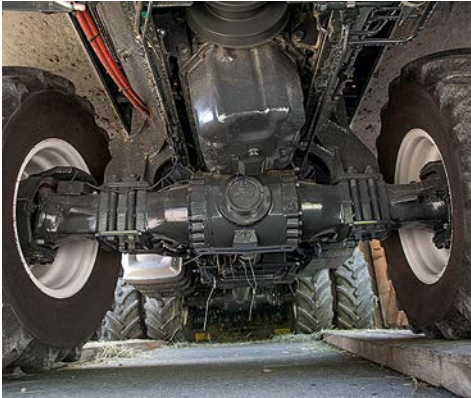
Die Baumschienenachsen von Dana (Spicer) haben eine Traglast von je 7 000 kg. Optional kann eine hydraulische Achsaufhängung eingebaut werden.
