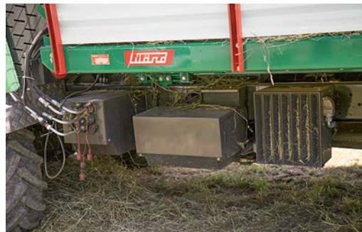
Links hinter der Kabine sind gut erreichbar die Anschlüsse der drei doppelt wirkenden, hydraulischen Steuergeräte sowie der Ölkühler des Getriebes zu finden.
