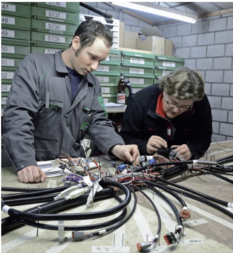
Jedes Kabel an seinem Ort. Funktionskontrolle der Kabelstränge vor dem Einbau.
